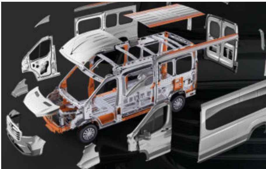
Sicherheitskarosserie aus verstärktem und hochfestem Stahl
